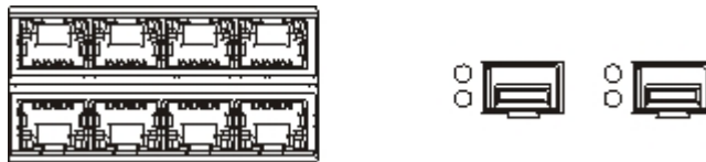
Figure 8. Connexion Ethernet 8 par 2 du Type 7199
